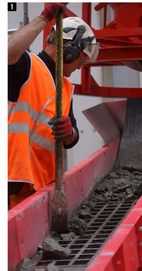
1 Aus der Betonmasse werden für die Versuche auf einem Rüttelsieb grosse Gesteinsbrocken aussortiert. 2 In diesem Gefäss wird der sogenannte Luftporengehalt des Frischbetons gemessen. 3 Frischbeton wird in kleine Kuben gegossen und danach unter anderem auf die Druckfestigkeit geprüft. 4 An den Betontests für den Bau der Spitallamm Staumauer sind auch externe Fachleute beteiligt. Fotos: Kraftwerke Oberhasli AG
