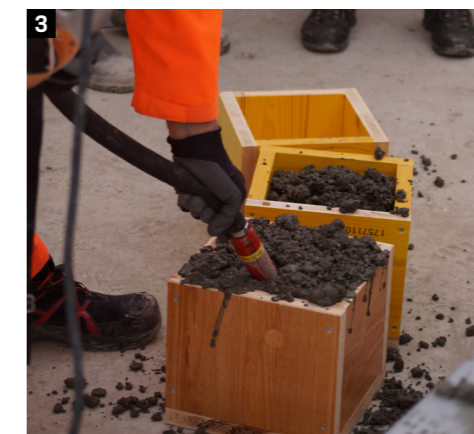
1 Aus der Betonmasse werden für die Versuche auf einem Rüttelsieb grosse Gesteinsbrocken aussortiert. 2 In diesem Gefäss wird der sogenannte Luftporengehalt des Frischbetons gemessen. 3 Frischbeton wird in kleine Kuben gegossen und danach unter anderem auf die Druckfestigkeit geprüft. 4 An den Betontests für den Bau der Spitallamm Staumauer sind auch externe Fachleute beteiligt. Fotos: Kraftwerke Oberhasli AG
